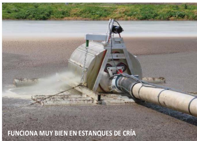
GRUPOS DE BOMBEO FLOTANTES POR GRAVEDAD
