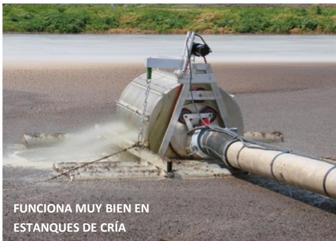
GRUPOS DE BOMBEO FLOTANTES POR GRAVEDAD
